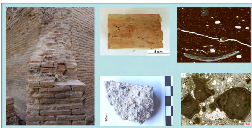
Figura 2. Materiales de construcción del Mudéjar aragonés: ladrillo y mortero de yeso.
