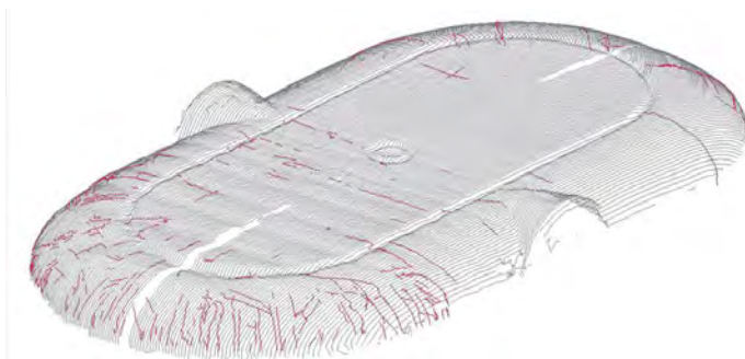
Figura 1. Imagen obtenida por escáner de deformaciones y fisuras de la bóveda encamionada del Salón de Plenos del Palacio del Senado de España.
