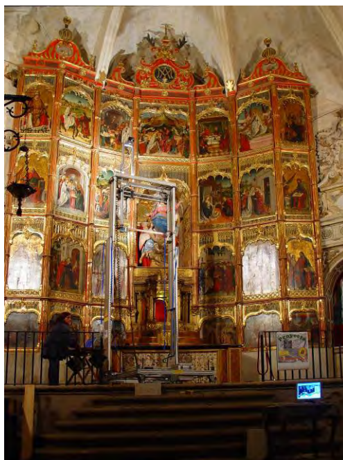
Figura 1. Prototipo mecanizado desarrollado por el IPCE en colaboración con la Escuela Técnica Superior de Ingenieros de Telecomunicación en el proyecto de investigación VARIM para la realización de reflectografía y radiografía in situ en grandes formatos. Imagen de Tomás Antelo.
